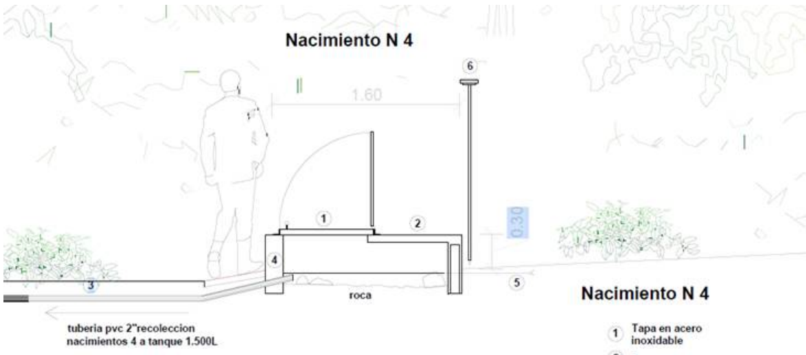
Imagen 11 Esquema corte detalle de la captación manantial 4.
