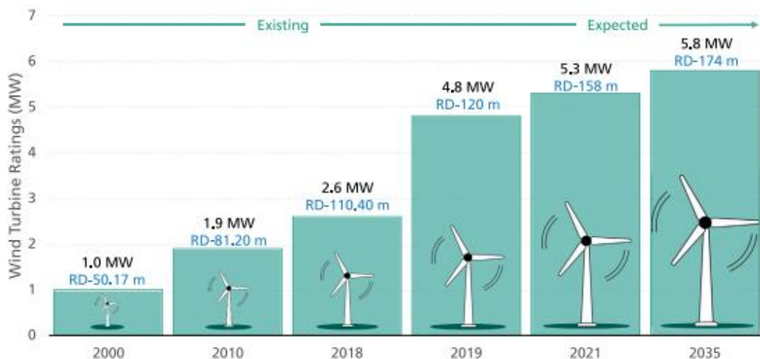
Figura 25. Aumento del rendimiento de los aerogeneradores terrestre [5].
