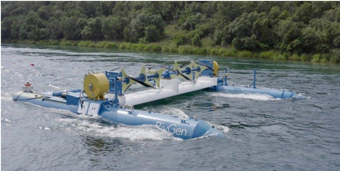
Figura 46. RivGen Power System - Turbina hidro cinética desplegada en Alaska [14].
