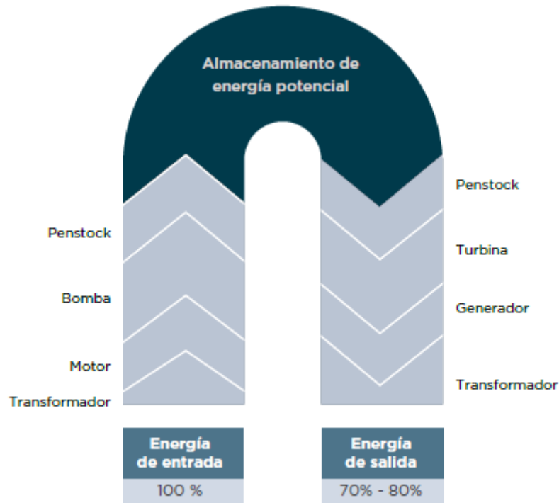
Figura 129. Eficiencia del ciclo hidroeléctrico de bombeo [1].
