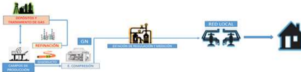
Figura 3. Red física de ductos de gas natural
